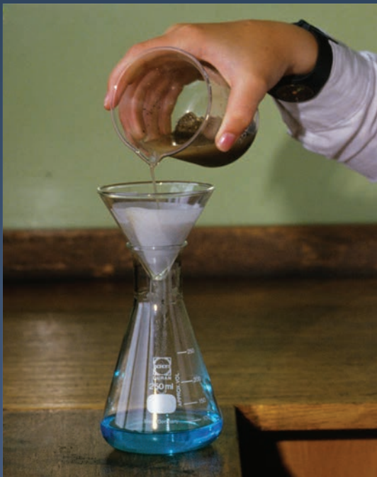
B | ეს ლაბორატორიული მოწყობილობა გამოიყენება ნარევი არსებული ნიადაგის ნიმუშის წყლისგან გამოსაყოფად.
