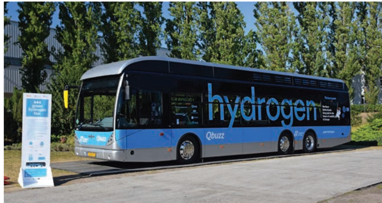
A | ფოტოზე ნაჩვენებ ავტობუსს „წყალბადის ელემენტი“ მიმდინარე ქიმიური პროცესის დროს გამოყოფილი ენერგია გარდაიქმნება ელექტრულ ენერგიად, რომელიც ამოძრავებს ავტობუსს.
