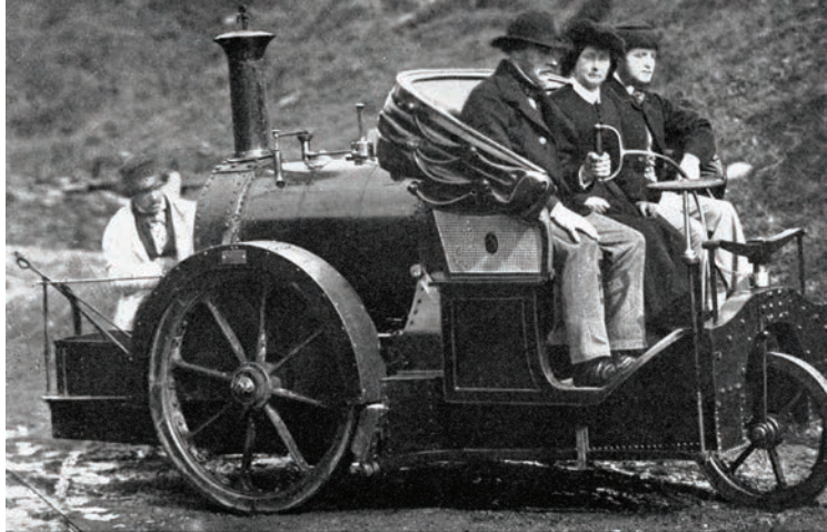
C | 1861 წლის ტომას რიკეტის ორთქლის მანქანაში საწვავად გამოყენებული იყო ნახშირი.
