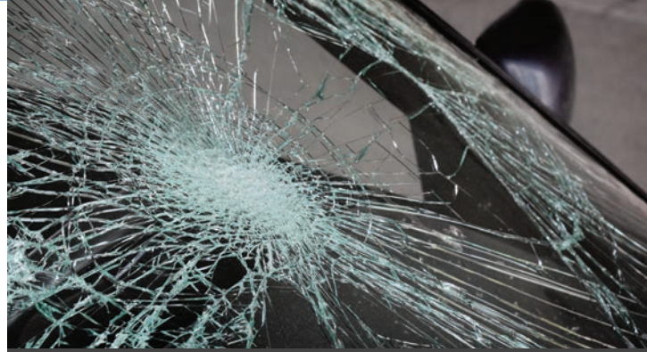
A | კომპოზიტური უსაფრთხო მინა გვიცავს მინის ნამსხვრევებით მიღებული დაზიანებისგან.
