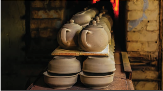
C | ფაიფურისა და თიხის ნაკეთობები მზადდება თიხის სხვადასხვა სახეობისგან და მუშავდება გამოსაწვავ ღუმელებში 1000°C ტემპერატურაზე.
